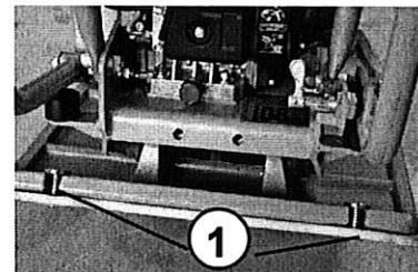
Pritvirtinkite kartu su laikikliu, varžtais, spyruokline poveržle ir veržlėmis (1) prie pagrindo plokštės iš priekio.
